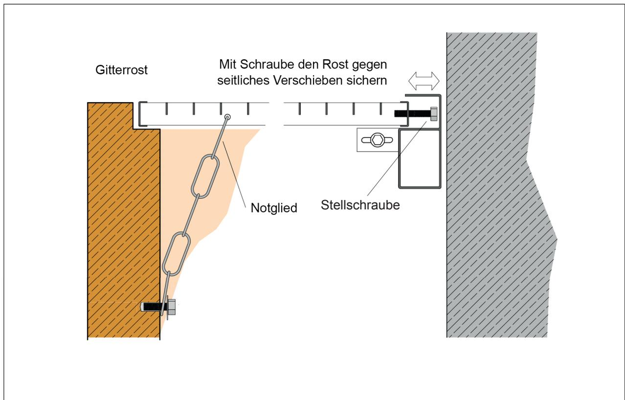
Zur Befestigung der Sicherungskette bzw. der Rostaufegerschiene sind Hülsendübel einbetoniert. Bei der Montage des Gitterrostes sind deshalb keine Bohrarbeiten nötig.
